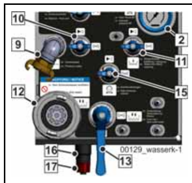
Fig. 200 (11) Fill / Rinse water box
